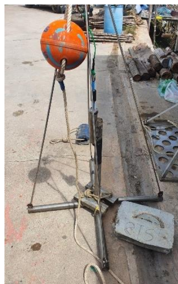
รูปที่ 3.4.7-25 : การติดตั้งอุปกรณ์ตรวจวัดทิศทางและความเร็วกระแสน้ำด้วย EM บริเวณปากคลองบางละมุง
