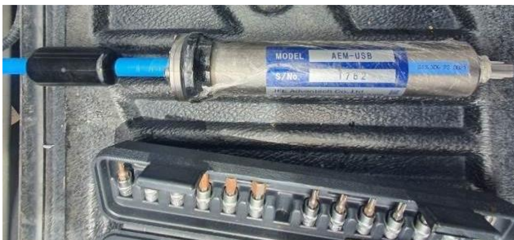
รูปที่ 3.4.7-21 : เครื่องมือตรวจวัดทิศทางและความเร็วกระแสน้ำแบบอัตโนมัติ รุ่น Logger version 2-D Electromagnetic Current Meter INFINITY-EM AEM-USB
