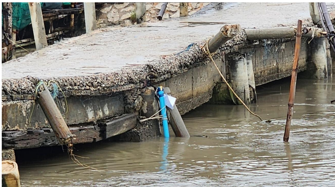
รูปที่ 3.4.7-32 : การติดตั้งเครื่องมือสำหรับการตรวจวัดข้อมูลระดับน้ำด้วย Water Level Logger ยี่ห้อ Onset รุ่น HOB0
