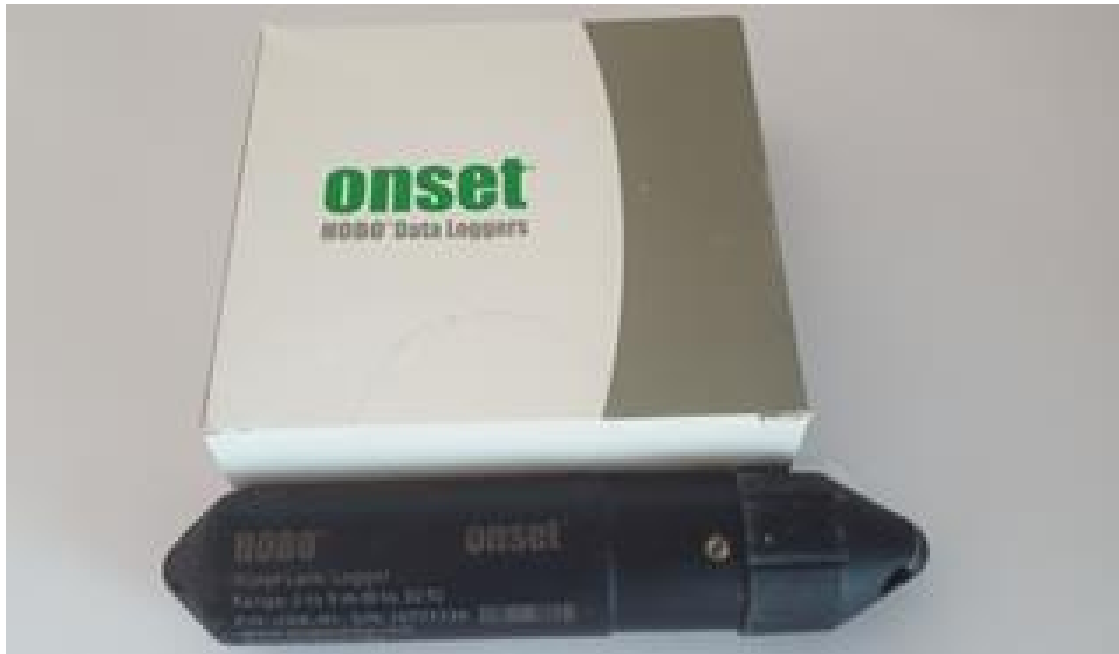
รูปที่ 3.4.7-29 : เครื่องมือตรวจวัดระดับน้ำแบบอัตโนมัติ Water Level Logger ยี่ห้อ Onset รุ่น HOBO®
